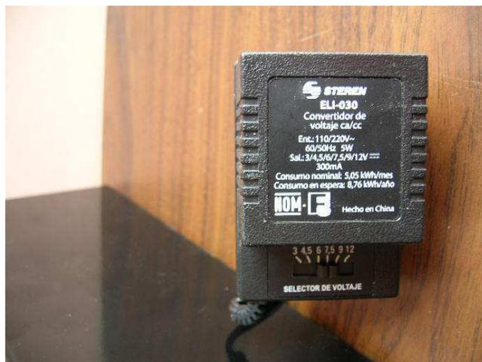
**EL SELECTOR DE VOLTAJE DEBE POSICIONARSE EN 6 Ó 7.5 VOLTS.**
