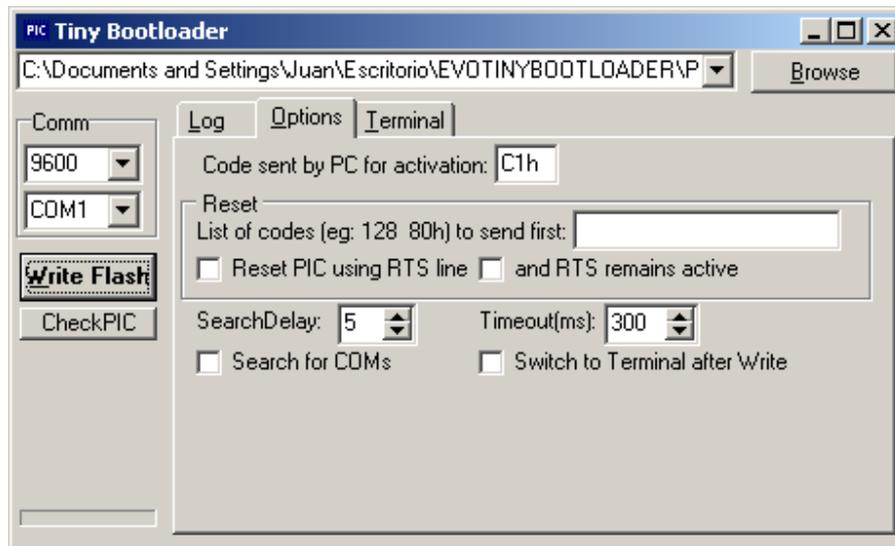
Debe conectarse un cable serial DB9 de la PC ó Laptop al Sistema EB88 ó bien una interfaz USB-Serial, cuidando de configurar adecuadamente el número del puerto COM en el software "TINY".
