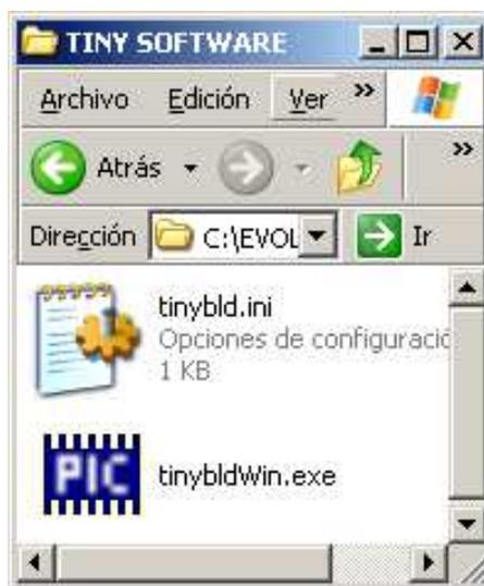
Abra el software *tinybldWin.exe*. La configuración para el software es: puerto: COM1 (ó el puerto COM que esté usando en ese momento), velocidad: 9600 bauds. En seguida se muestran las ventanas:
